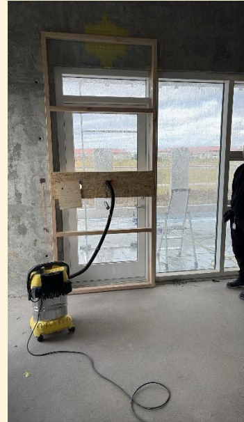
Ryksuga myndar 1100 þa þrýstingsmun úti og inni
